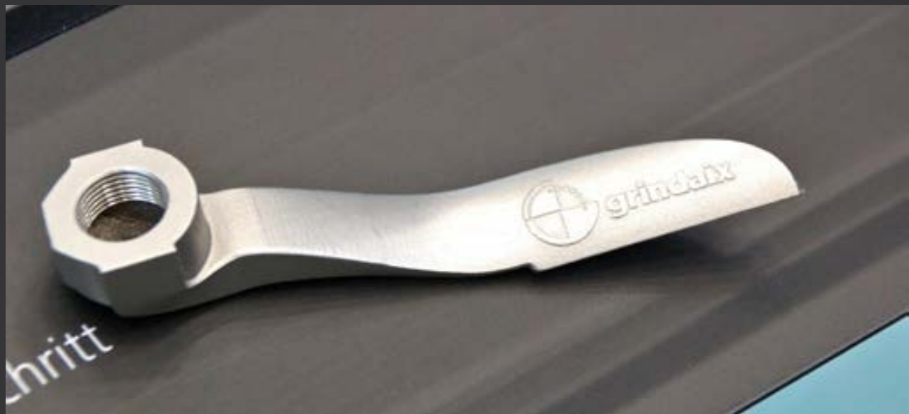
Grindaix heeft bij het ontwerpen van deze nozzle voor slijpmachines de functie voorop gezet, daar is de vorm uit voortgekomen.
